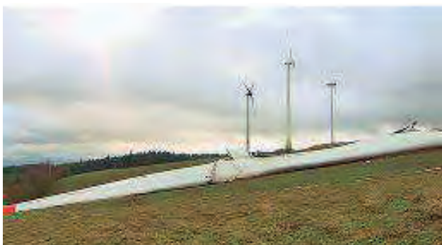
Der abgebrochene 60 t - Flügel des Windrades
